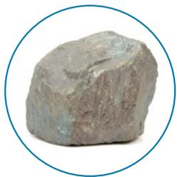
Eisensilikat-Gestein mit einer Kantenlänge von bis zu 450 mm, vergleichbar mit Eruptivgestein
