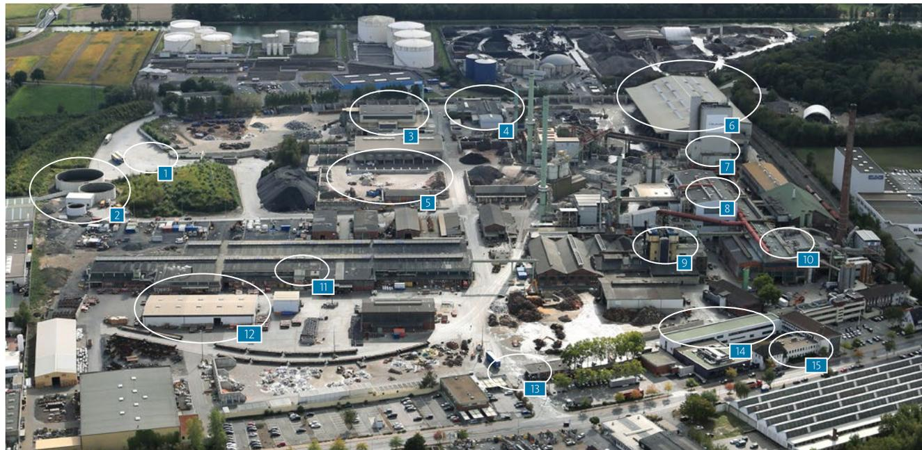
1 Werkszufahrt Süd mit Lärmschutzwall 2 Regenwasserrückhaltung 3 Materialvorbereitung 4 Probenahme 5 E-Schrott-Aufbereitung 6 Lagerhalle 4
