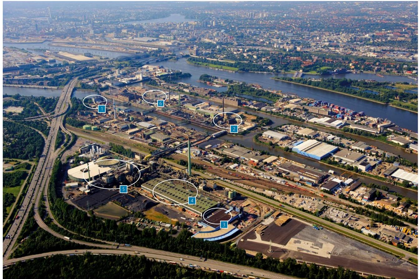
1 Stranggussanlage 2 Sekundärhütte/Edelmetalle 3 Drahtanlage 4 Elektrolyse 5 Rohhütte Werk Ost 6 Verwaltung
